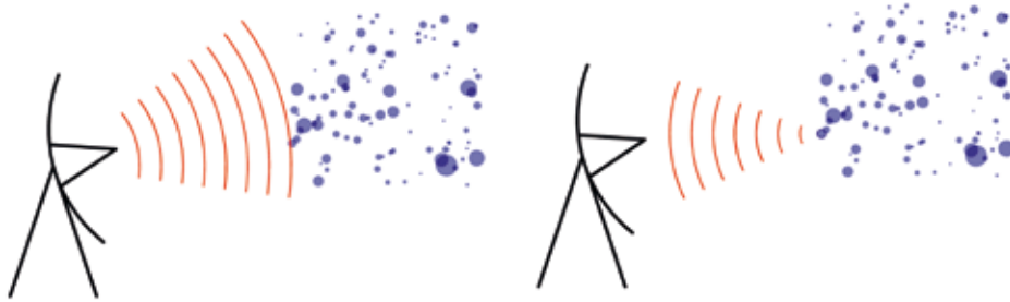
Figuur 2.10 De werking van radar, uitgezonden en teruggekaatst signaal
