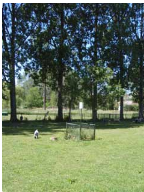
Figuur 2.4 Verkeerde opstelling regenmeter: te dicht bij bomen
