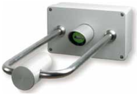
Figuur 2.7 Een optische disdrometer (bron: www.thiesclima.com/disdrometer.html )
