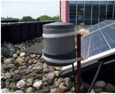
Figuur 2.8 Akoestische disdrometer (bron: www.tudelft.nl )
