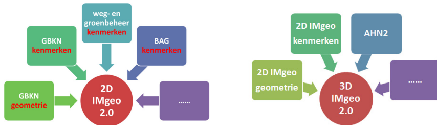
Figuur 2 Schematische weergave van de GIS-keten om te komen tot het 3D-stadsmodel
