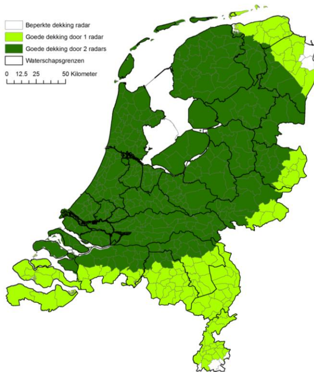
Fig. 1. Gemiddelde dekking van de Nederlandse radars.
