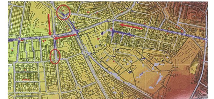
2D maaiveld + bovengrondse afstroming
